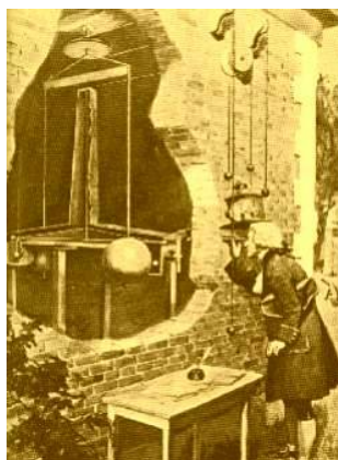
図 3.13 キャベンディッシュによる万有引力定数の測定 (Wikimedia commons より)
