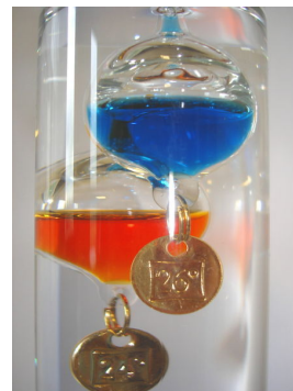
図 6.4 ガリレオ式温度計。ガラス円柱内に液体を入れ、さらのその液体と比重が少しだけ違う球状のおもりをいくつか入れてある。温度により円柱内の液体の比重が変化すると、浮いているおもりの個数が変化することにより温度がわかる。(Wikipedia(en):Galileo Thermometer より)
