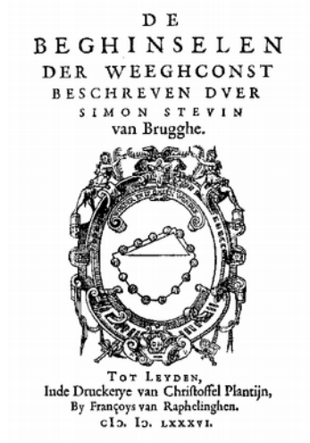
図 3.17 ステヴィンが1586年に出版した「つりあいの原理」の表紙。ステヴィンによる力のつりあいの実験が描かれている。ちょうど斜面の長さに比例した個数の球が斜面上にあるとき球は静止する。三角形の下にある球はその左右対称性より斜面上の力のつりあいには影響しない。図は wikipedia より
